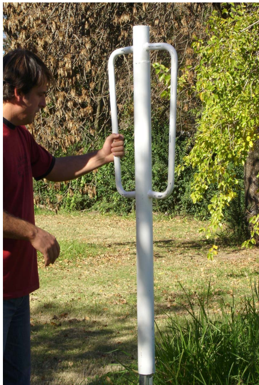
Martinete o colocador de postes metálicos
